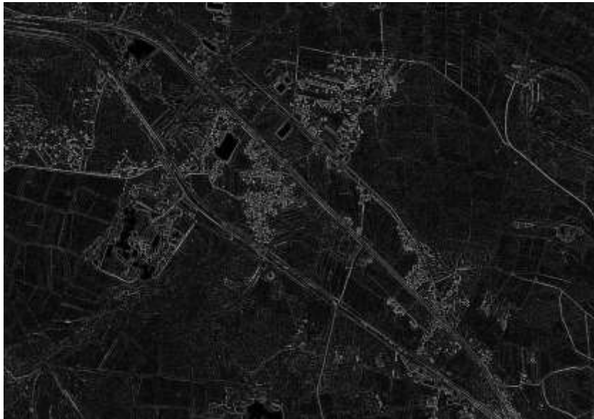
Figura 2. Detector de bordes utilizando el detector de Canny.
