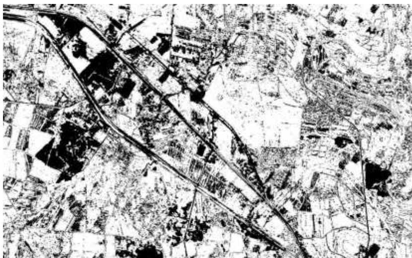
Figura 1. (a) arriba y 1 (b) abajo: (1a) Clasificación de caminos utilizando el algoritmo de agrupamiento K-Means con 40 clases y (1b) binarización de la imagen clasificada.
